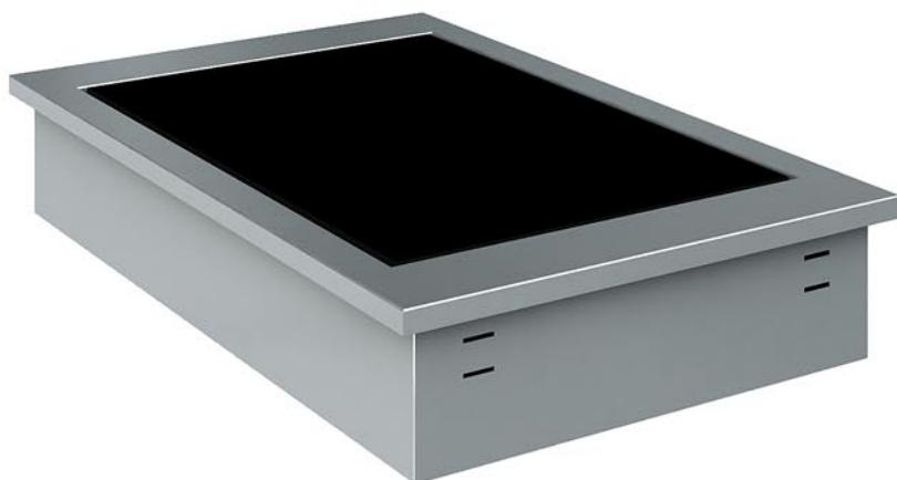
Piano di mantenimento da incasso, realizzato in vetroceramica e acciaio inox AISI 304. Regolazione della temperatura da +30°C ÷ +110°C tramite termostato. Ideale per esporre pietanze in piatti o su vassoi.
